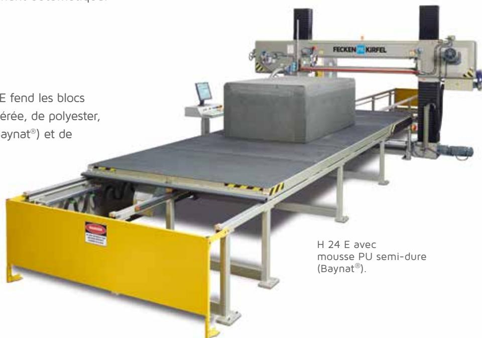
H 24 E avec mousse PU semi-dure (Baynat®).
