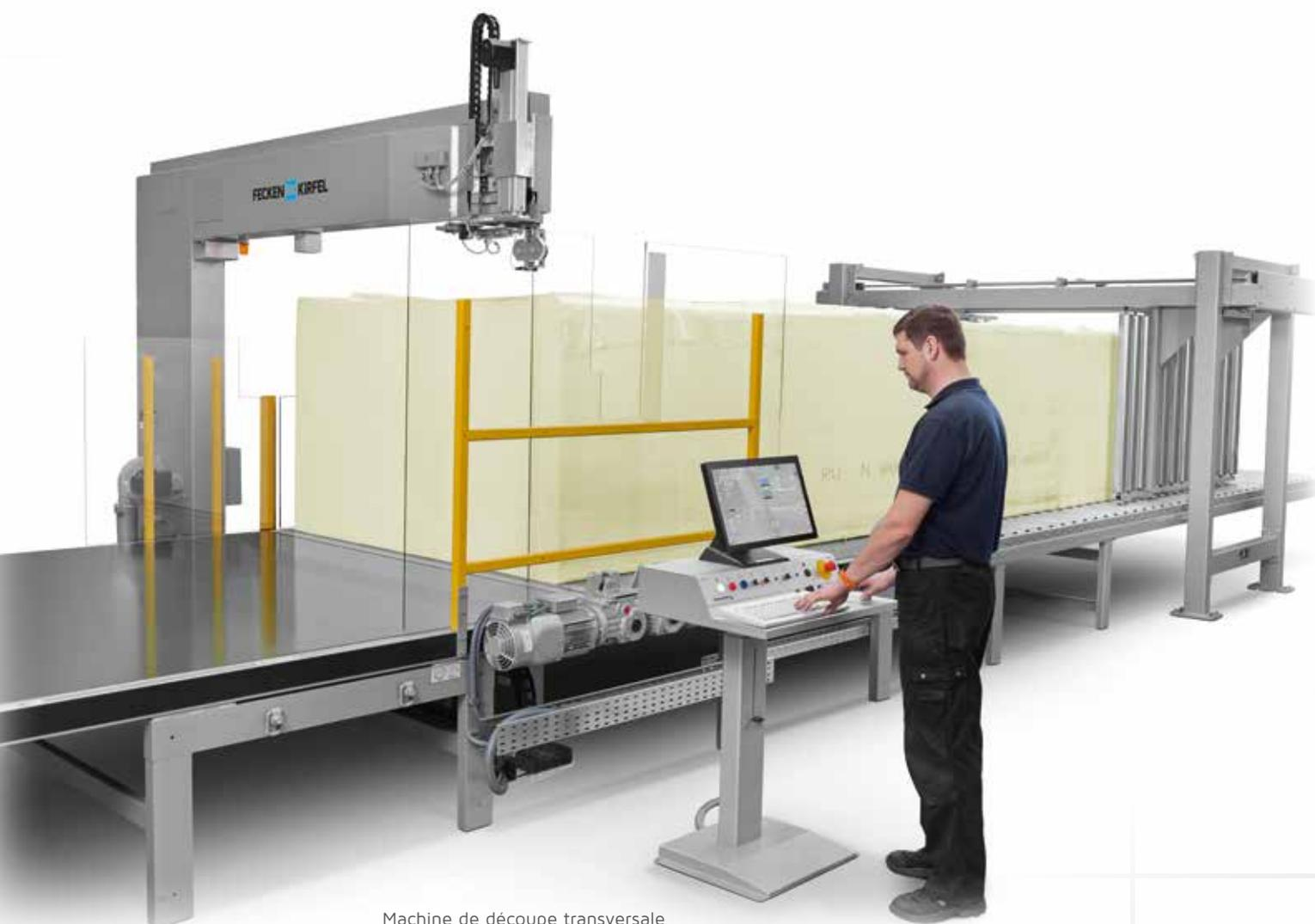
Machine de découpe transversale et de rognage T 8 avec guidage latéral.
