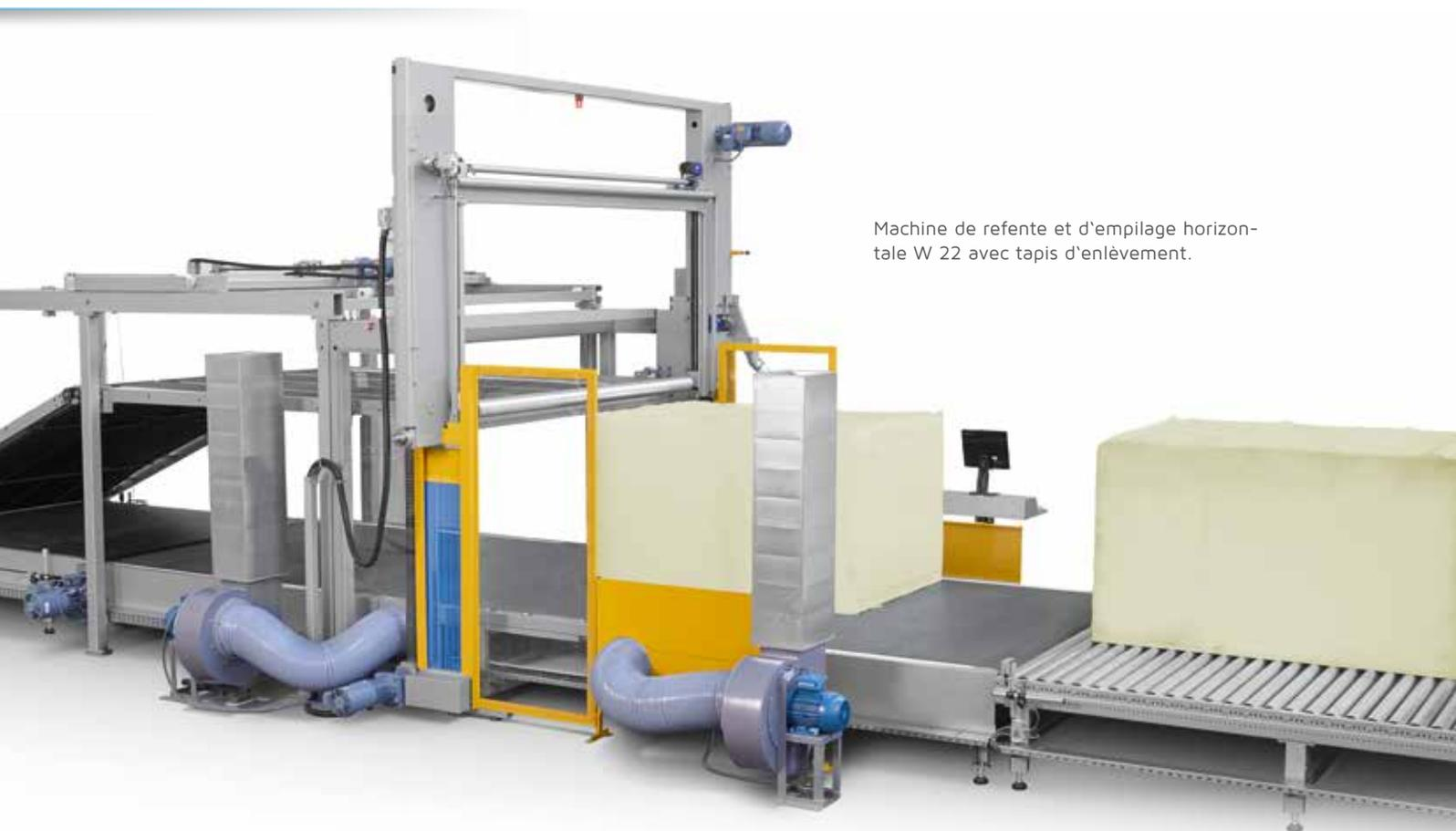
Machine de refente et d'empilage horizontale W 22 avec tapis d'enlèvement.
