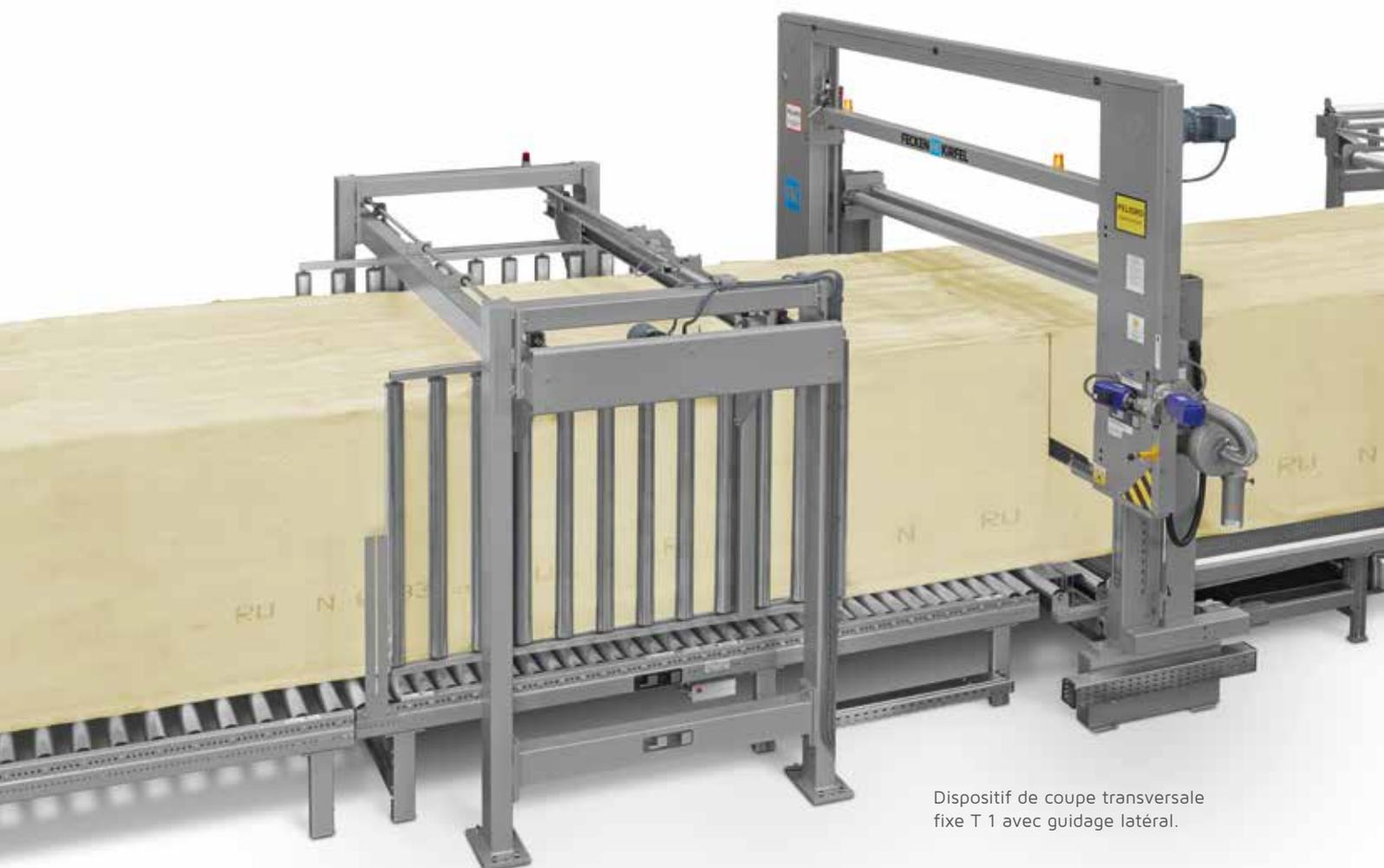
Dispositif de coupe transversale fixe T 1 avec guidage latéral.
