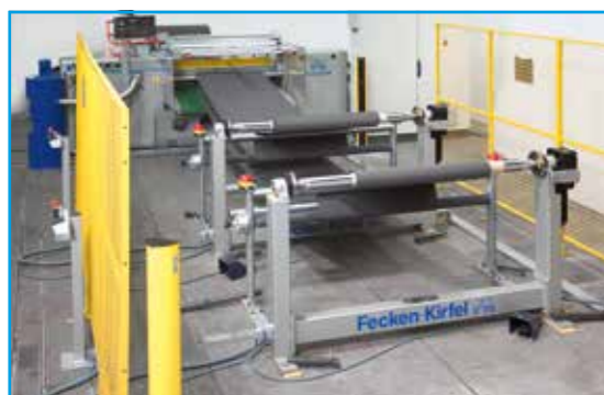
Machine à refendre K 21 et R10 et deux R 39
