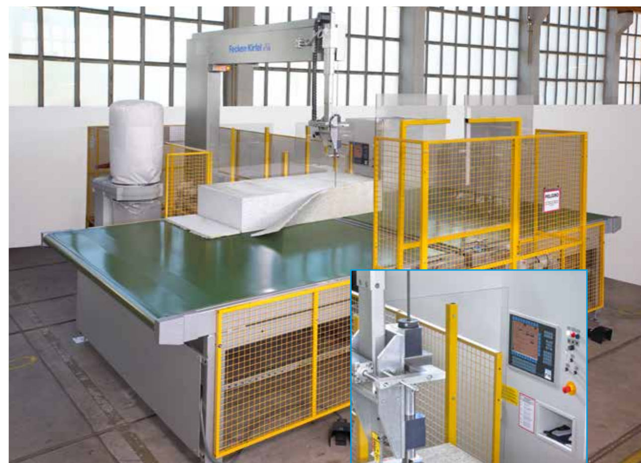
Machine de rognage T 8 S
