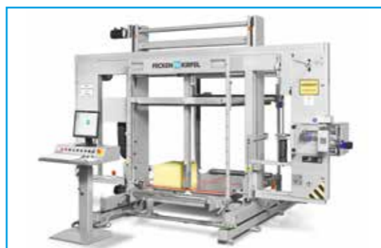
Centre CNC de découpe en forme horizontale C 56
