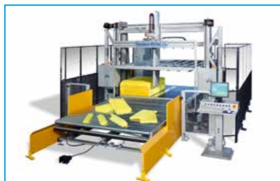
Centre CNC de découpe en forme horizontale C 69
