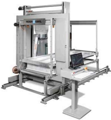
Ein weiterer Clou: Die Überwachung des Schneidwiderstandes passt automatisch die Schneidgeschwindigkeit an. Eine leistungsstarke Absäuge reduziert die Staubentwicklung auf ein Minimum. Der Plattenniederhalter kann während des Schnittes bei einem Zusammensacken des Materialblocks heruntergefahren werden. Ein Servomotor beschleunigt den Schneiddraht auf bis zu 324 km/h. Um einen Längenausgleich sicherzustellen, wird die Drahtspannung dabei überwacht und automatisch mittels Pneumatik eingestellt.
