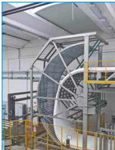
Lors du processus de refente, une tour de la Loop glisse automatiquement et compense la longueur à mesure que le bloc devient plus fin. Outre les blocs collés en continu, la machine permet également de refendre les blocs sans collage et des blocs individuels.
