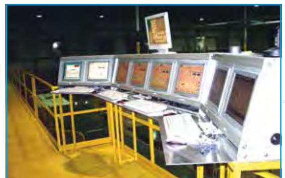
Die gesamte Anlage ist über ein zentrales Bedienterminal fernsteuerbar. Dies reduziert den Personaleinsatz auf ein Minimum. Der aktuelle Produktionsstatus kann jederzeit überwacht werden.
